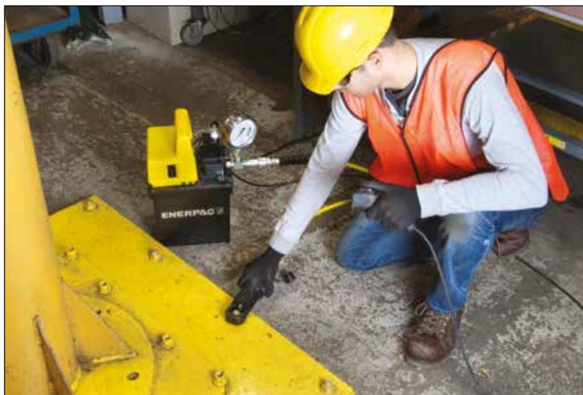
◀ Насос с погружным мотором обеспечивает быстрый и бесшумный привод гидравлического гайкореза при работах по техническому обслуживанию.
